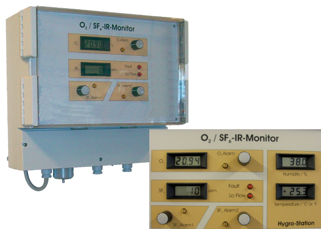
Прибор для контроля за выбросами элегаза и кислорода Модель GA38 с гигростанцией
