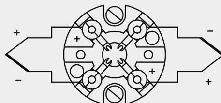
Für die Zuordnung Polarität - Klemme gilt immer die farbliche Kennzeichnung der Plus-Pole am Gerät
