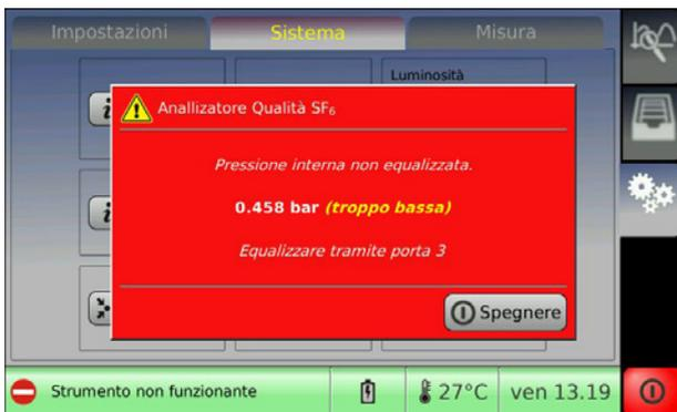
Per la compensazione della pressione, connettere un sacchetto di recupero del gas con il gas desiderato (sotto pressione atmosferica, max. 1.300 mbar) all'uscita per il sacchetto di recupero del gas ③.
