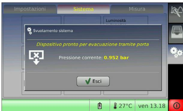
5. La schermata seguente indica che è necessaria subito una compensazione della pressione. La schermata scompare automaticamente quando è stata seguita correttamente una compensazione della pressione.
