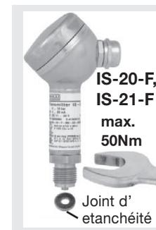
Pour le modèle IS-20-S/-F le joint est livrable en option. Pour le modèle IS-21-S/-F le joint fait partie de la livraison.
