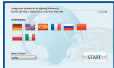
После соединения с преобразователем (с помощью PU-548) при нажатии на клавишу "Start" загружается конфигурационный интерфейс.
