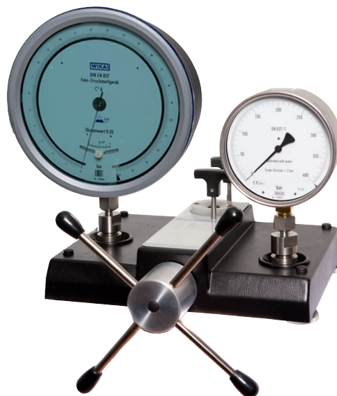
Conjunto de calibração CPP4000-X com manômetro de teste como instrumento de referência e item de teste
