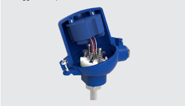
Quando si utilizzano sensori doppi in combinazione con un trasmettitore singolo, il sensore 1 viene collegato al trasmettitore. I cavi di collegamento del sensore 2 (isolati da cortocircuiti) fuoriescono in modo libero nella testa di connessione.
