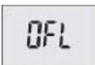
Der gemessene Druck ist außerhalb des Messbereichs (Full Scale). Erscheint diese Anzeige auch im drucklosen Zustand, nehmen Sie bitte Kontakt mit WIKA auf.
